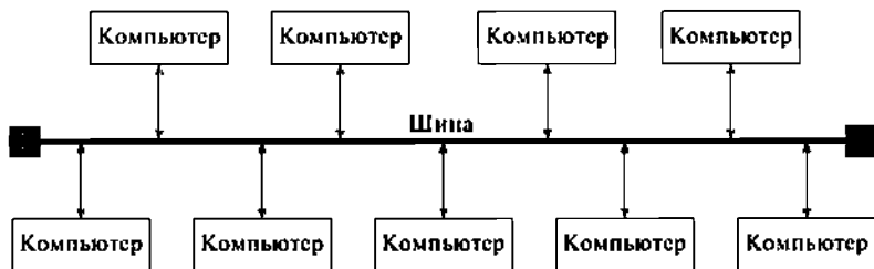
Рис. 14.1. Топология сети «шина»
